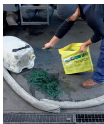
Gelijkmatig op de lekkage strooien ...
