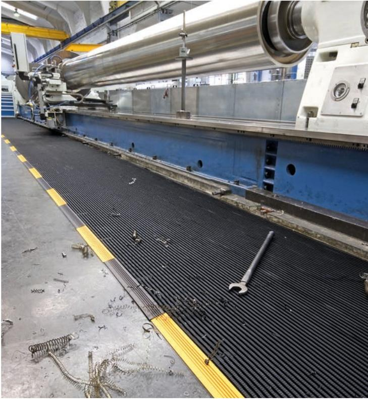
Die EHA – Industriematten +11 eignen sich besonders für Arbeitsplätze mit erhöhter Rutschgefahr. Durch die gefräste Lauffläche wird eine geprüfte Rutschhemmung von R11 erreicht. Das weiche elastische Material ermöglicht ein ermüdungsarmes und angenehmes Stehen und Gehen.
