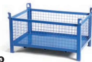
Cu plasă - tip ușurat al paletului de îngrădire în varianta cu ochi 50 x 50 mm, Ø sârmei 3,15 mm.
