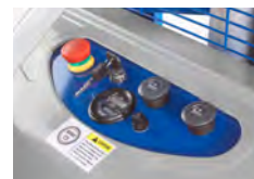
Элементы управления, индикатор заряда аккумулятора, выключатель с замком
