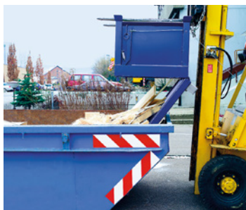
Svuotare completamente: sbloccare il fondo apribile mediante fune
