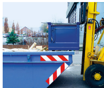
Dopo lo svuotamento: il fondo apribile si chiude automaticamente quando viene appoggiato
