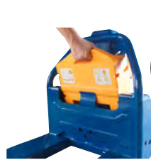
Changement d'accumulateur en quelques secondes
