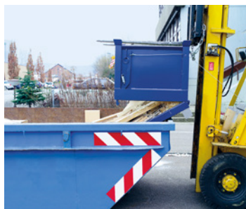
Vidage progressif: poser le conteneur sur le bord de la benne ou sur le sol, déverrouiller, remonter, le fond s'ouvre en fonction de la vitesse de levée
