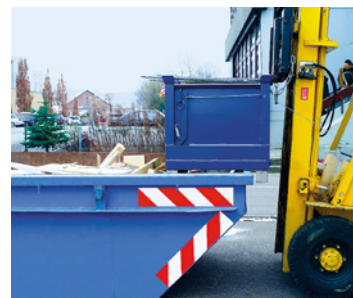
Après le vidage: abaisser le conteneur vide, le fond se verrouille automatiquement
