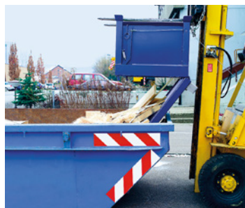
Vidage complet: ouverture du fond à l'aide de la commande par câble
