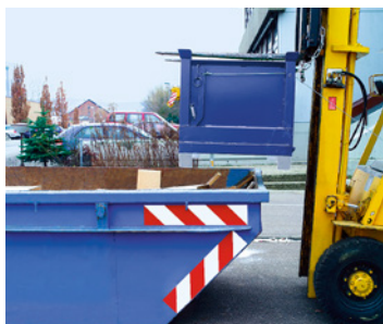
Amener le conteneur au-dessus de la benne
