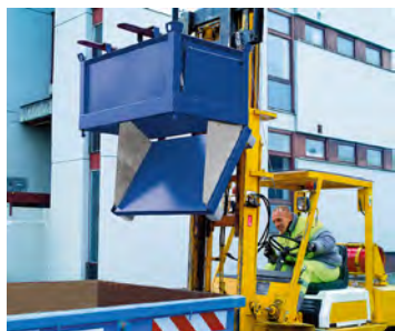
Zentrierwände an der Bodenklappe, verhindern Seitenstreuung
