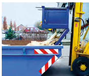
Restlos entleeren: Bodenklappe über Seilzug entriegeln
