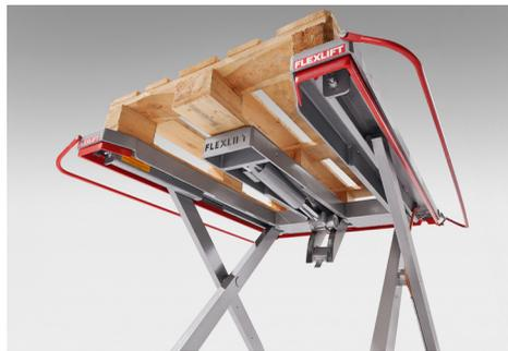
Hydraulikzylinder verdeckt und geschützt gegen Beschädigungen
