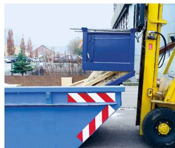
Dosiert entleeren: auf Containerkante oder Boden aufsetzen – entriegeln – hochfahren, die Bodenklappe öffnet sich entsprechend der Hubgeschwindigkeit
