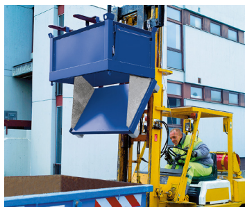
Zentrierwände an der Bodenklappe, verhindern Seitenstreuung
