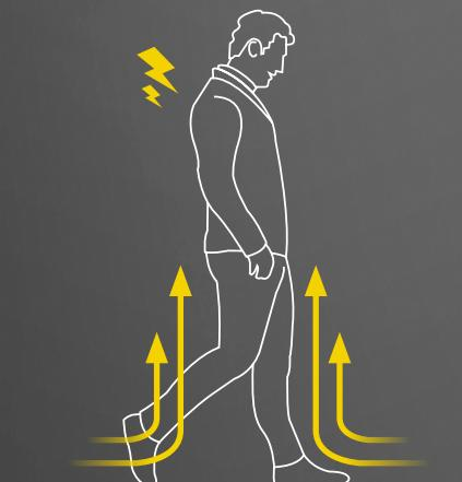
Do elektrostatičkog pražnjenja dolazi primjerice kod hodanja. Pritom tijelo dobiva naboj. Tijelo može primiti visoke naboje.
