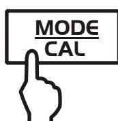
С помощью этой функции производится сохранение веса тары. И после выключения/включения весы также продолжают работать с сохраненным значением тары.
