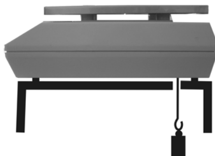
Výkres 1: Postavení váhy k vážení pod podlahou
