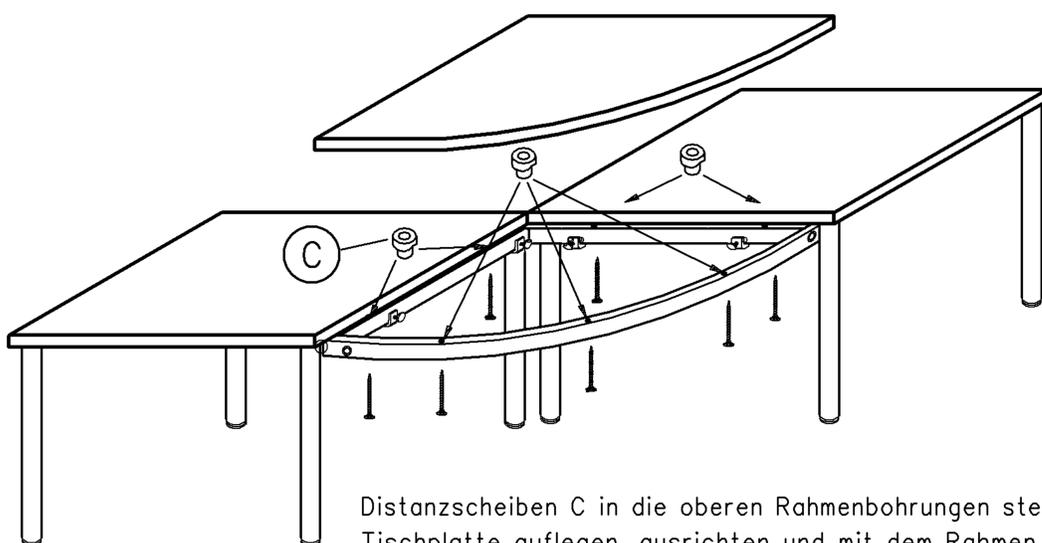
Distanzscheiben C in die oberen Rahmenbohrungen stecken. Tischplatte auflegen, ausrichten und mit dem Rahmen verschrauben.
