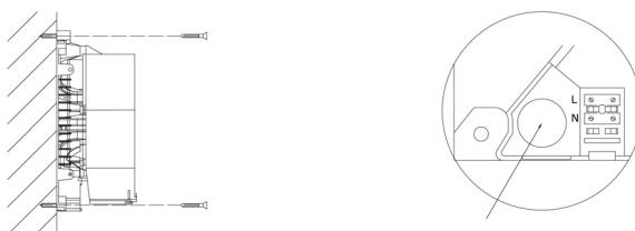
ОТВЕРСТИЕ ДЛЯ КАБЕЛЯ ЭЛЕКТРОПИТАНИЯ.
