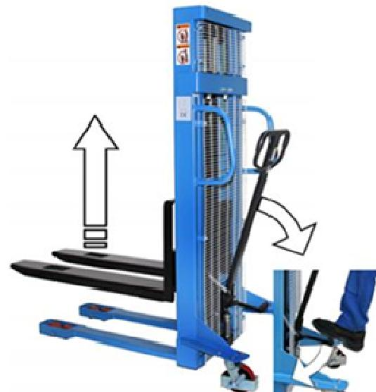
**Figure 1 Utiliser de la barre de traction**
