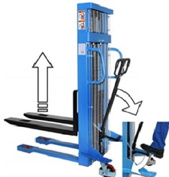
**Figura 1 El uso de la barra de tracción**
