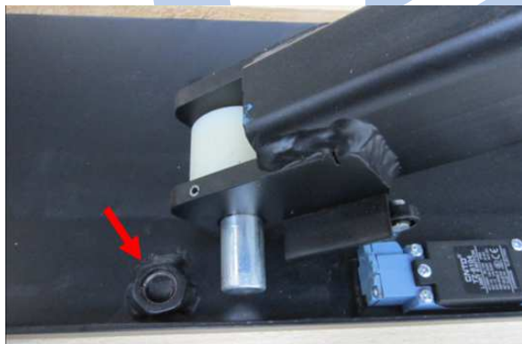
Bilde 8 Montering av transportbolter 1
