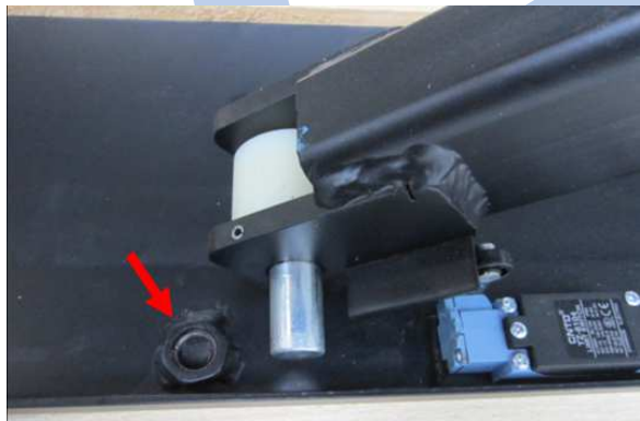
Obrázok 8 Montáž transportnej skrutky 1
