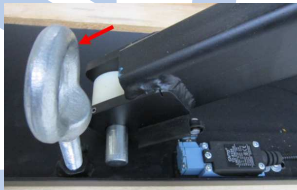
Slika 9: Namestitev transportnega sornika 2
