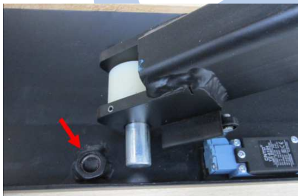
Рис. 8 Установка транспортирных болтов 1
