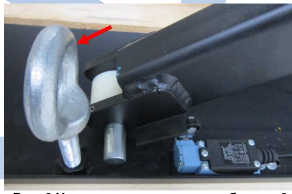
Рис. 9 Установка транспортирных болтов 2
