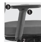
**Armelehen Nr. 175/176:** höhenverstellbar (10 cm; Taste ① drücken), werkzeuglos breitenverstellbar (3,5 cm); Exzenterverschluß ② öffnen – Armlehne in gewünschte Position schieben – Exzenterverschluß ② schließen, tiefenverstellbar ③ (6 cm; Pad nach vorn oder hinten führen). Beidseitig schwenkbar um 30° ④.
