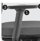
**Braccioli N° 175/176:** regolabili in altezza (10 cm; premere il tasto ①), regolabili in larghezza (3,5 cm) senza l'impiego di strumenti; aprire la chiusura ad eccentrico ② - fare scorrere i braccioli nella posizione desiderata - chiudere il blocco ad eccentrico), regolabili in profondità ③ (6 cm; portare il pad in avanti o all'indietro). Orientabili su entrambi i lati di 30° ④.
