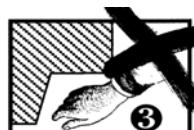
**V nobenem primeru ni dovoljeno z deli telesa, kot so roke, noge ali glava, posegati pod dvignjen tovor.**
