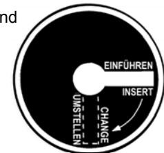
Jetzt führen Sie den Umstellschlüssel mit dem langen Teil vorsichtig bis zum Anschlag in das Schlüsselloch an der Tür-Innenseite ein und drehen den Schlüssel RECHTS herum bis zum markierten Anschlag.
