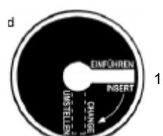
Bu aşamada, set anahtarının uzunca kısmını işaretli direnç noktasına kadar kapının iç kısmında bulunan anahtar deliğine koymak ve anahtarı SAĞA çevirmek.
