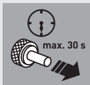
Abb. 3e: Warten und Loslassen des Gasventil-Knopfes
