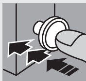
Abb. 3c: Drücken des Gasventil-Knopfes
