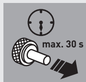
Abb. 3d: Warten und Loslassen des Gasventil-Knopfes
