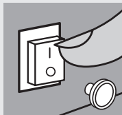
Fig. 3a : Démarrage du ventilateur de l'
