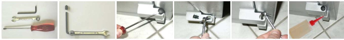
Pour graisser les charnières faites couler quelques gouttes d'huile dans la fente entre la partie haute et la partie basse de la charnière (image n°5) et essayez l'excès éventuel. Toutes les huiles de graissage standard conviennent.
