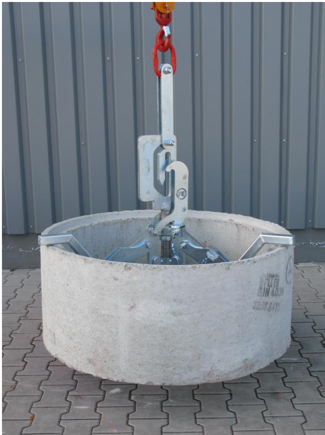
Bild B Aufhängeeisen in Position „Last heben“
