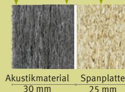
Wandaufbau mit Dämpfung
