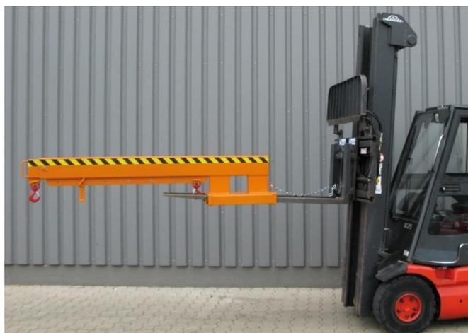
Neue Reichweiten schafft der Kranarm-Aufsatz für Gabelstapler: massive Konstruktion aus Profilrohren, verschweißt und verschraubt, in 7 Stufen verstellbar.
