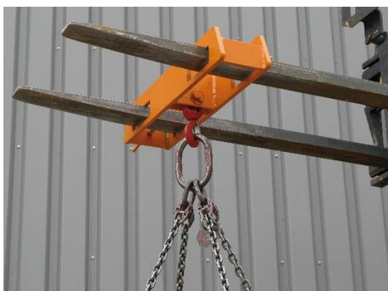
Ein unentbehrliches Hilfsmittel für vielfältigste Aufgaben: Der doppelarmige Stapler-Aufsatz mit Wirbel-Lasthaken sorgt für eine mittige Traglast-Verteilung auf zwei Staplergabeln. Die Fixierung an den Staplergabeln erfolgt über eine seitlich liegende Flügelschraube. In zwei Ausführungen für unterschiedliche Traglast.
