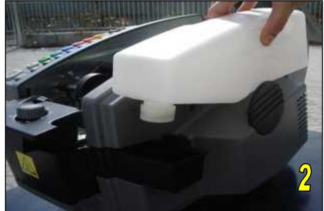
**5.2 INUMIDIMENTO DEI PENNELLI:** per attivare il sistema di inumidimento delle spazzole, lavarle con acqua calda saponata prima della messa in funzione, quindi montarle nella vaschetta in modo che il lato con altezza maggiore si trovi in posizione anteriore (come si vede nell'immagine 1). Inserendo la bottiglia l'inumidimento rimane costante.
