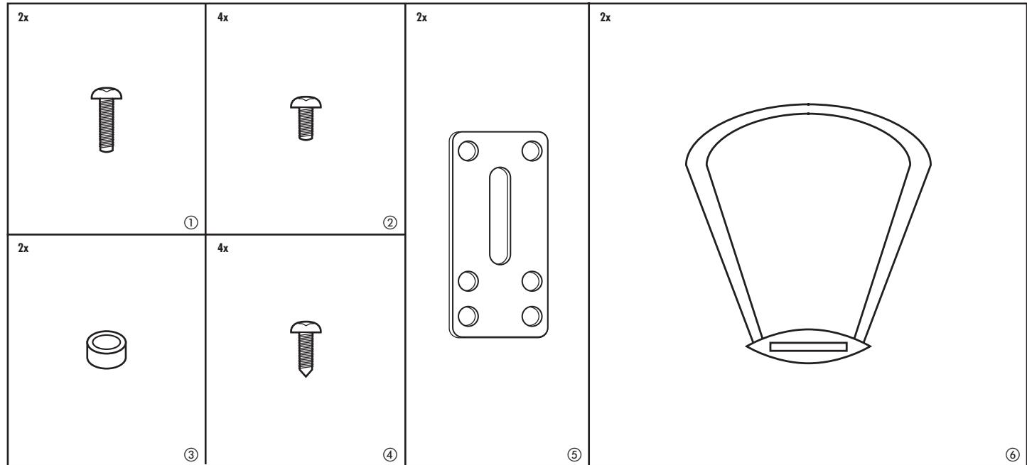
**DEUTSCH** **Achtung!** Bitte alle Schrauben ein- bis zwei Gewindegänge eindrehen. Sind alle Schrauben fixiert und die Polster bzw. Armlehnhen ausgerichtet, können Sie die Schrauben fest anziehen!
