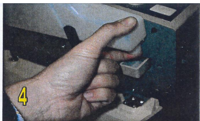
Töltsük meg vízzel a műanyag tartályt. A kifolyó nyílást ujjunkkal fogjuk be, majd a tartályt úgy helyezzük be, hogy a nyílás a víztartó mélyedésébe kerüljön (4.ábra). A baloldali műanyag fedelel és a mellső fedelel ismét zárjuk le. A vízsint a víztartóban a következőképpen szabályozható: a tartály elülső tartó csavarját csavarjuk le és a víztartályt helyezzük a megfelelő pozícióba.
