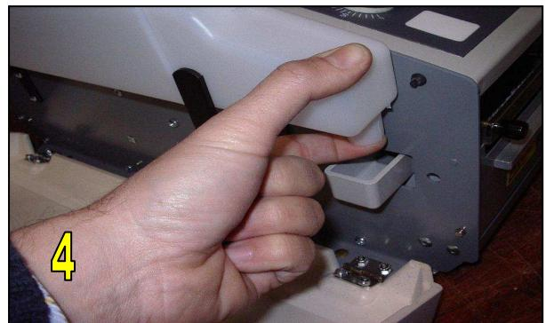
Posodo iz umetne mase za vodo napolnite z vodo. Podržite iztočni nastavek in posodo znova namestite v držalo tako, da nastavek moli v izbokljino rezervoarja za vodo (slika 4). Ponovno zaprite levi stranski pokrov iz umetne mase in sprednjo loputo. Nivo vode v zbiralniku za vodo je mogoče regulirati takole: Odvijte vijak sprednjega držala posode in namestite držalo posode v ustrezен položaj.
