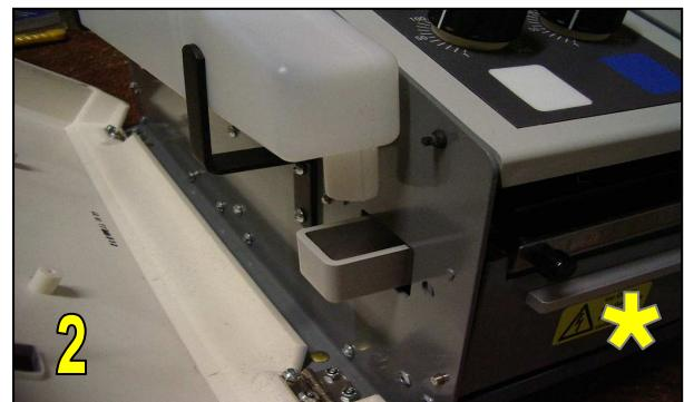
Para a activação do sistema capilar de ambos os pincéis de humidificação, antes da primeira utilização, lavá-los com água de sabão quente. Introduzir os pincéis no depósito de água, de forma a que os cantos mais altos fiquem à frente (imagem 3). Colocar novamente o recipiente para a água na máquina.
