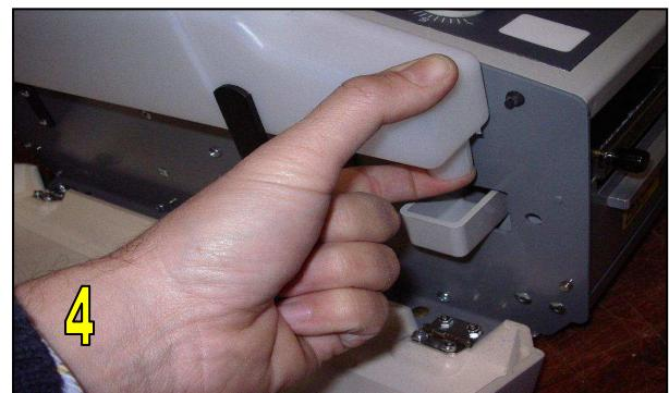
Encher a garrafa de plástico com água. Tapar o bico de descarga e colocar a garrafa novamente no suporte, de forma a que o bico fique saliente na proeminência do depósito de água (imagem 4). Fechar novamente a tampa lateral de plástico esquerda e a frontal. É possível regular o nível de água do recipiente de água do seguinte modo: Desapertar o parafuso do suporte frontal da garrafa e colocar o suporte na respectiva posição.
