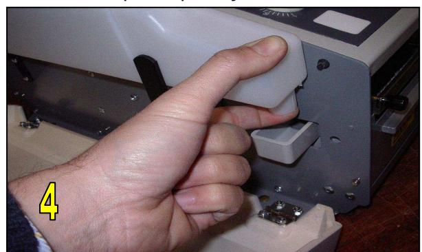
Naplňte plastovou láhev vodou. Přidržte výpustné hrdlo a vložte láhev zpět do držáku tak, aby hrdlo vyčnívalo do prohlubně v nádržce na vodu (obrázek 4). Uzavřete levý boční plastový kryt a přední kryt. Množství vody v nádržce na vodu lze regulovat následujícím způsobem: Uvolněte šroub předního držáku láhve a uveděte držák láhve do vhodné polohy.
