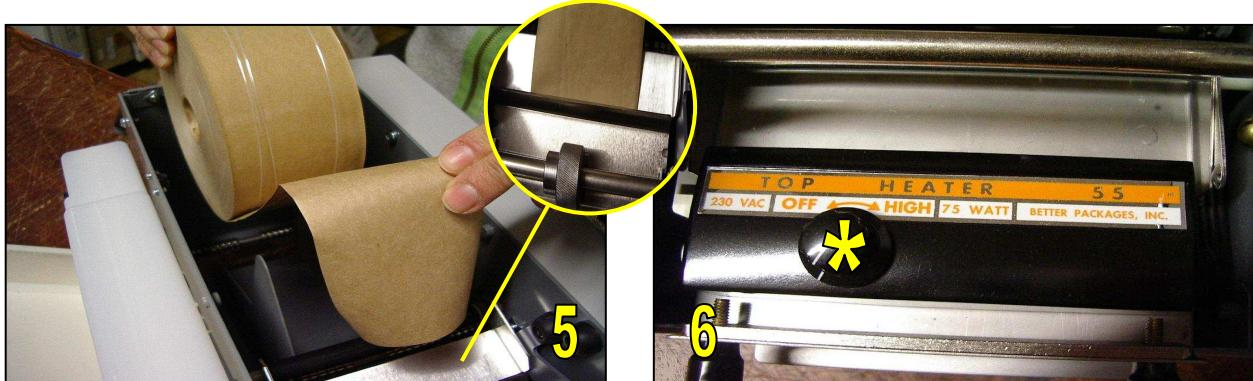
**5.5 RISCALDATORE.** Per migliorare le proprietà collanti del nastro, l'apparecchio è dotato di un riscaldatore installato sulla spazzola di inumidimento e regolabile in modo continuo mediante una pomolo (\*). Per selezionare la temperatura desiderata, ruotare la manopola in senso orario (OFF a sinistra, HIGH a destra) . In condizioni normali, regolare la manopola in posizione intermedia per ottenere una temperatura ottimale che verrà mantenuta costante da un apposito termostato. (img.6)
