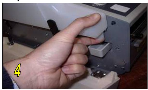
Naplnite plastovú flašu na vodu vodou. Pridržte výpustné hrdlo a nasadte flašu do držiaka tak, aby hrdlo vycnievalo do vyklenutia nádrže na vodu (obrázok 4). Lavý bocný plastový kryt a celnú klapku znova zatvorte. Stav vody v nádrži na vodu je regulovateľný nasledovne: Uvolnite skrutku na prednom držiaku flaše a držiak flaše uvedte do príslušnej polohy.
