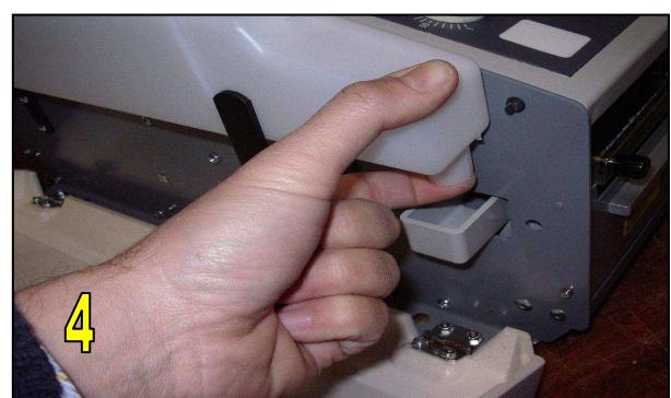
**5.4 INSERIMENTO DEL ROTOLI DI CARTA.** Per l'inserimento del rotolo di carta gommata : centrare le guide del rotolo nell'alloggiamento, lasciando un gioco sufficiente. Introdurre il nastro per ca. 5 cm. sotto l'apposita piastra di guida, come si vede nel cerchio (img.5) con il lato gommato rivolto verso il basso. Chiudere il coperchio grigio della macchina, ed il supporto della tastiera.
