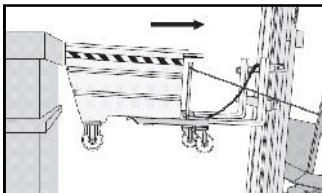
Il contenitore automaticamente si posiziona orizzontalmente e si riaggancia al fermo meccanico. Rimettere l'anello di sicurezza alla leva di sgancio cassone. Riportare il contenitore al proprio posto di raccolta.
