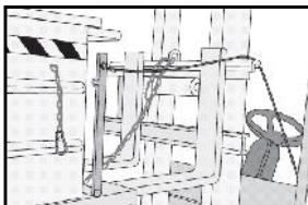
Positionner au niveau de la cabine le câble servant à la manipulation du levier d'ouverture
