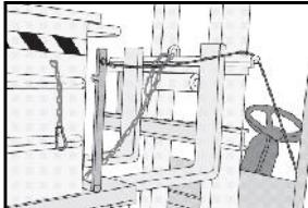
Coloque el cable de la palanca por encima del soporte/guía de las horquillas.
