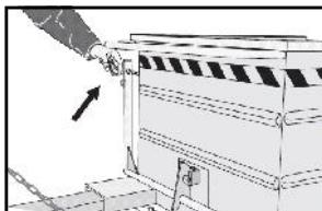
Retire el gancho de la palanca de seguridad.
