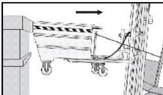
El contenedor basculante vuelve a su posición horizontal automáticamente. Vuelva a colocar el anillo de seguridad de la palanca. Vuelva a colocar el contenedor basculante en su lugar de recogida.
