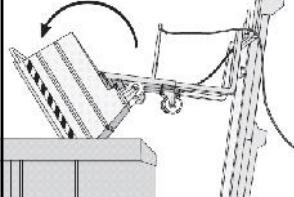
Elevar el contenedor unos 10cm del suelo. Desplazarse a la zona de descarga. Elevar el contenedor basculante por encima del contenedor de residuos. Avanzar con la carretilla. Tirar del cable para la liberar la palanca y realizar la maniobra de volteo. El contenido caerá automáticamente dentro del contenedor de residuos.
