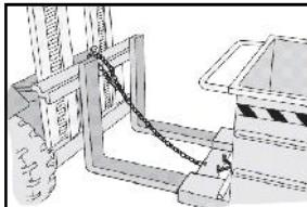
Enganche la cadena de seguridad del contenedor al soporte/guía de las horquillas de la carretilla.
