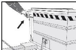
Enlever le mousqueton de sécurité positionné sur le levier d'ouverture de la benne
