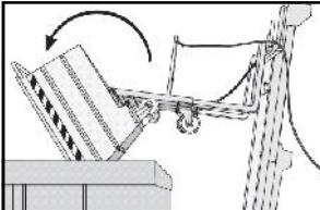
Sollevare di circa 10 cm il contenitore. Portarsi presso la zona di scarico. Sollevare il contenitore ad una altezza appena superiore a quella del cassone di scarico. Avanzare fino a sovrapporre il contenitore al cassone di scarico. Tirare il cordino in modo da sganciare la leva di blocco; a questo punto il contenitore si ribalta e scarica il suo contenuto nel cassone sottostante.
