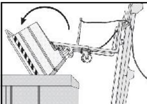
Zdvíhnite kontajner o 10 cm. Presun na vykladacie plochou. Zdvíhnite nádoby pri výške len väčšie, než je z tela výfuku. Advance pre vloženie kontajnera telo do kanalizácie. Vytiahnite kábel uvoľnite páčku, na ktorom mieste sa obrátil prípad a sťahovať jeho obsah do poľa nižšie.
