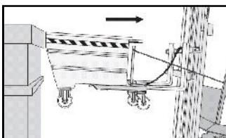
Kontejner se automaticky stává horizontální a zavěste mechanickou zarážku. Vyměňte pojistný kroužek na těle uvolnění páky. Vraťte nádobu na místo odběru.
