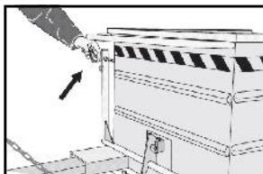
Entfernen Sie den Sicherheitshaken vom Freilassungshebel des Behälters.
