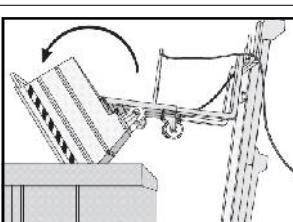
Om de kantelcontainer te ledigen: Plaats de kantelcontainer boven de rand van de verzamelcontainer. Rij naar voren met de vorkheftruck tot de kantelcontainer boven de verzamelcontainer geplaatst is. Om de kantelcontainer te ledigen trekt men aan het koord om het kantelmechanisme te ontgrendelen.
