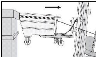
Ilpojemnik automatycznie staje poziome i odłóż mechaniczny ogranicznik. Wymienić pierścień do korpusu dźwigni zwalniającej. Powrót pojemnika do miejsca odbioru.
