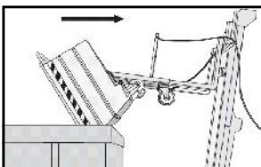
Reculer de façon à recouvrir avec la benne le rebord du conteneur de décharge
