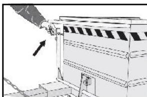
Odstranite kljuko iz varnostne ročice sprostite telo.
