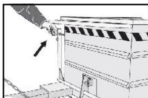
Снимите крюк с предохранителем освободить тело.
