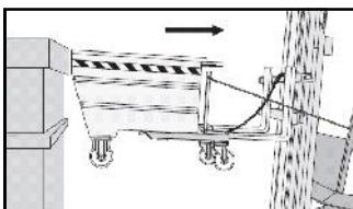
Kontajner sa automaticky stáva horizontálne a zaveste mechanickú zarázku. Vymeňte poistný krúžok na tele uvoľnenie páky. Vráťte nádobu na miesto odberu.
