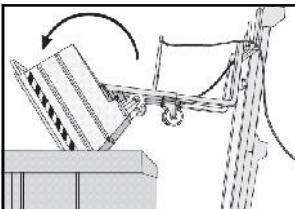
Levante o recipiente de cerca de 10 cm. Mover-se a zona de descarga. Levantar o recipiente a uma altura maior do que apenas o do corpo de escape. Avançar para sobrepor o corpo de recipiente para drenar. Puxe o cabo para liberar a alavanca de bloqueio, altura em que o caso é invertido e baixar seus conteúdos na caixa abaixo.
