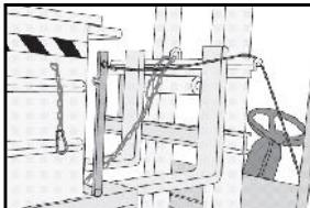
Positionieren Sie das Zugseil des Freilassungshebels beim Fahrersitz.
