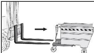
Positionner les fourches à l'intérieur des fourreaux en maintenant les montants en position verticale. Si nécessaire agir sur l'écartement des fourches.
