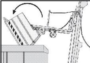
Zvedněte kontejner o 10 cm. Přesun na vykládací plochou. Zvedněte nádoby při výšce jen větší, než je z těla výfuku. Advance pro vložení kontejneru tělo do kanalizace. Vytáhněte kabel uvolněte páčku, na kterém místě se obrátil případ a stahovat jeho obsah do pole níže.
