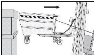
Der Behälter positioniert sich automatisch horizontal und hackt sich wieder am mechanischen Anschlag ein. Bringen Sie den Sicherheitsring wieder am Freilassungshebel des Behälters an. Befördern Sie den Behälter an seine übliche Sammelstelle.
