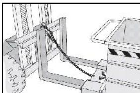
Fixer la chaîne de sécurité de la benne à la barre transversale du chariot élévateur
