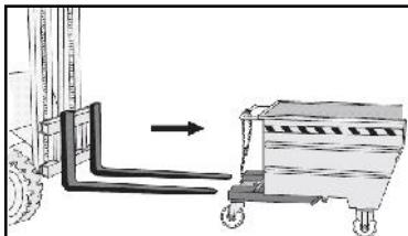
Colocar os garfos em caixas apropriadas de inforcazione mantendo os postes de elevação do transporte numa posição vertical. Se necessário, para actuar sobre a alavanca para o centro dos pontos de inserção dos garfos.
