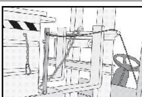
Plaats het trekkoord van het kantelmechanisme naast de bestuurdersstoel
