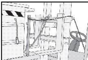
Postavite kabel za sprostitev ročice na mestu prevoz navodila.
