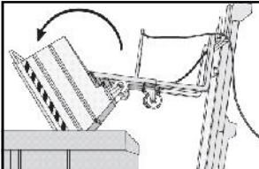
Soulever le conteneur d'environ 10 cm. Se déplacer vers la zone de manutention. Soulever la benne basculante légèrement au-dessus du bord du conteneur de décharge. Tirer le câble servant à l'ouverture. La benne bascule et libère tout son contenu.
