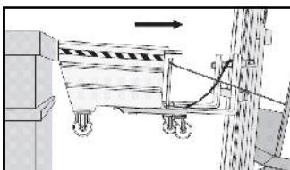
O recipiente torna-se automaticamente na horizontal e em seguida, desligue o batente mecânico. Substitua o anel para o corpo alavanca de liberação. Devolva o recipiente ao seu local de coleta.
