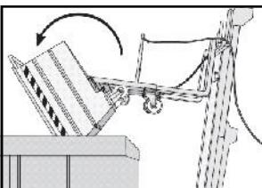
Dvignite posodo približno 10 cm. Premik na območja za raztovarjanje. Dvignite posodo na višini le večja, kot jo telo izpuha. Advance prikažete kontejnerjev telo odteče. Potegnite kabel za sprostitev zaklep, na kateri točki se obrne tako in prenesti vsebino v polje spodaj.
