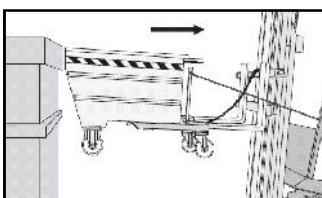
Контейнер автоматически становится горизонтальным, а затем повесить механического упора. Замените стопорное к телу рычага освобождения. Вернуться контейнер на место сбора.
