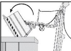
Unieś pojemnik o 10 cm. Przenieś na terenie rozładunku. Podnieś kontener na wysokość większą niż po prostu z korpusu z rury wydechowej. Advance nałożenie korpusu kontenera do kanalizacji. Ciągnąć za przewód, aby zwolnić dźwignię blokady, w tym momencie sprawa jest odwrotna i pobrać jego zawartość w polu poniżej.
