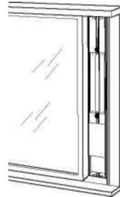
4. Stopfen Sie die Schaumstoffdichtung A zwischen das Glas und das Fenster, um zu verhindern, dass Luft und Insekten in das Zimmer gelangen.
