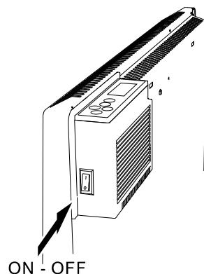
Verwenden Sie die Einschalt- / Stand-by-Taste, um den Konvektor ein- und auszuschalten, ohne die gespeicherte Uhrzeit zu verlieren.
