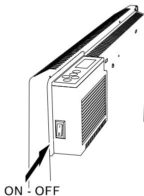
Gebruik de aan/uit Stand-by knop op het bedieningspaneel om de convектор in of uit te schakelen zonder de opgeslagen tijd en dag te verliezen. Display geeft huidige dag en tijd, na het inschakelen gaat de convector in comfort modus.
