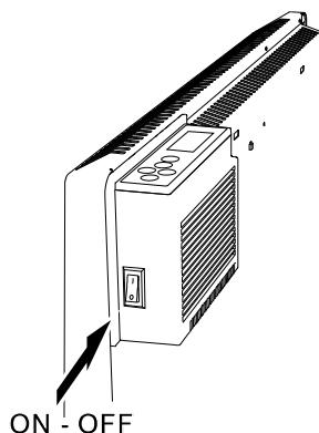
Utilizați butonul Power / Stand-by pentru a porni și opri convectorul fără a pierde timpul memorat.
