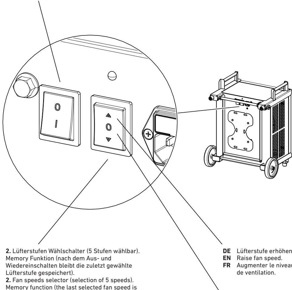
**DE** 2. Lüfterstufen Wähl schalter (5 Stufen wählbar). Memory Funktion (nach dem Aus- und Wiedereinschalten bleibt die zuletzt gewählte Lüfterstufe gespeichert).
