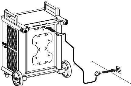
**DE** Netzkabel zuerst am Gerät, dann an der Steckdose einstecken.
