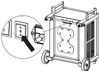
**DE** **Filterwechsel-Anzeige zurücksetzen:**
