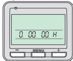
D Betriebsstunden des Heizungssystems
