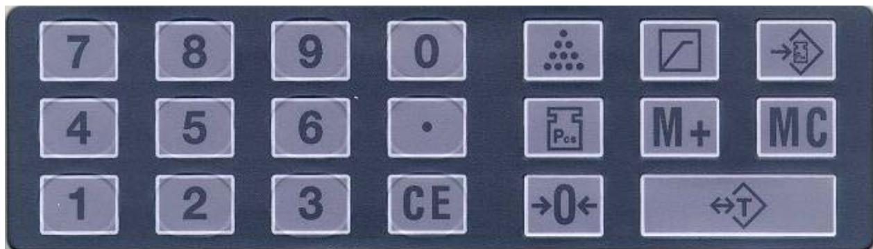
0 ile 9 ve Bu tuşlarla parça ağırlığı, parça sayısı ya da dara ağırlığı giriliyor.
