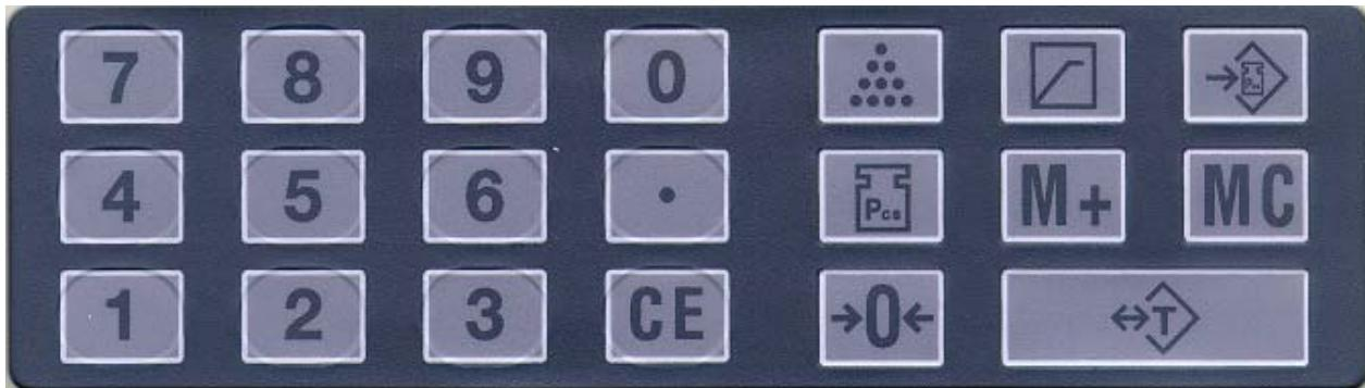
0 do 9 i Mediante estas teclas se introduce el pesaje de unidad, cantidad de unidades o pesajes de tara.
