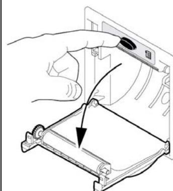
4) Kağıdı biraz açın ve doğru konumda olmak üzere (kağıdın başlangıcı arkada olacak ve yukarı doğru bakacak), resimde gösterildiği üzere yerleştирin.
