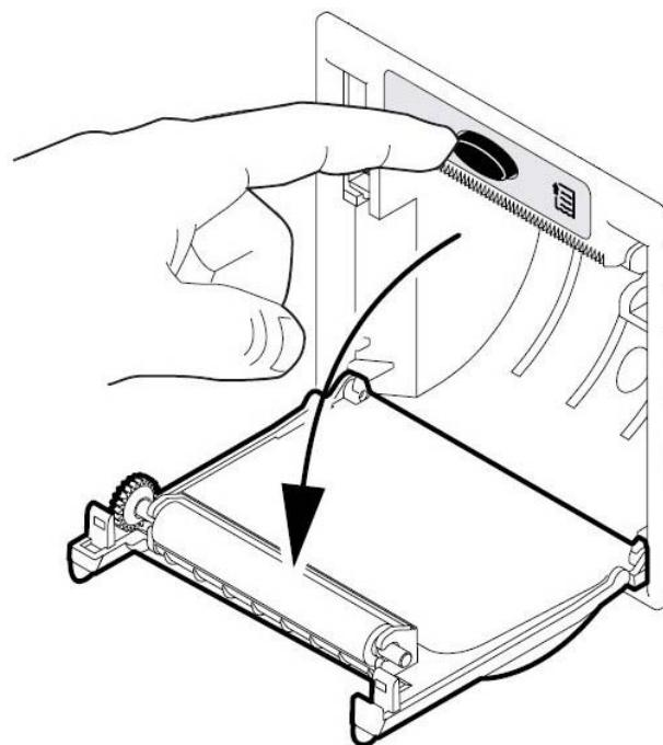
17.)Dérouler un peu le rouleau du papier et le mettre en position appropriée (le bord du rouleau dirigé vers arrière et vers le haut), voir la figure ci-contre.
