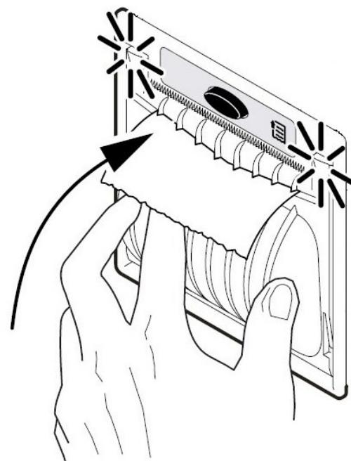
19.) Enlever l'excès du papier en faisant l'usage du bord tranchant situé au-dessus.
