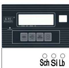
Links neben der Sicherung befindet sich ein Schalter (Sch) zum ein- und ausschalten der Anzeige und wenn vorhanden gleichzeitig für den Drucker.
