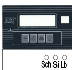
Til venstre for sikringen befinner sig en kontakt (Sch) til at tænde og slukke for displayet og hvis tilstede samtidigt for printeren.
