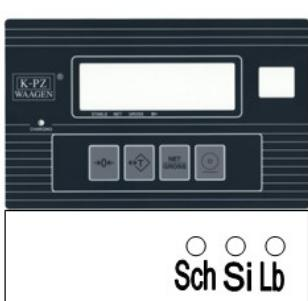
A biztosítéktől balra a kijelző valamint a nyomtató (amennyiben feltelepítve) kapcsolója található (Sch)
