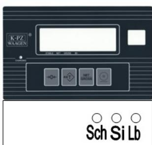
Gniazdo ładowania (Lb) znajduje się z przodu, z prawej strony pod wyświetlaczem. Z lewej strony znajduje się bezpiecznik 1A (Si). Bezpiecznik chroni elektronikę przed prądem przeciążeniowym. Jeżeli nie można włączyć wyświetlacza, wówczas należy sprawdzić bezpiecznik i ewentualnie wymienić go.
