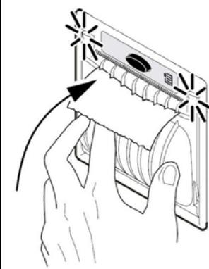
4.) Entfernen Sie das nicht benötigte Papier über die Abrisskante.
