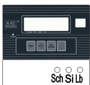
Latausliitintä (Lb) sijaitsee etuosan oikealla puolella näytön alla. Vasemmalla sijaitsee 1A-sulake (Si). Sulake suojelee laitteen elektroniikkaa ylikuormitusvirralta. Mikäli näytöö ei voida kytkeä pois päältä, sulake on tarkastettava ja tarvittaessa uusittava.
