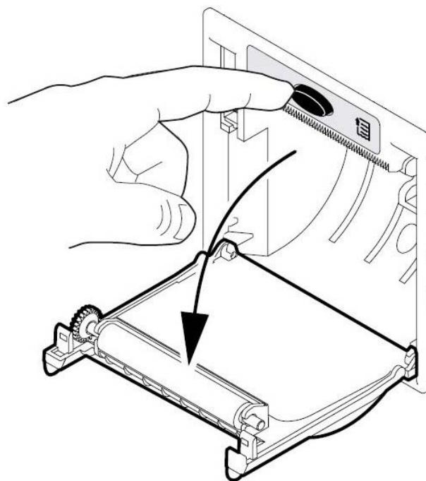
47.) Развернуть немного бумажного ролика и разместить в соответствующем положении (начало ролика назад и вверх), как на рисунке
