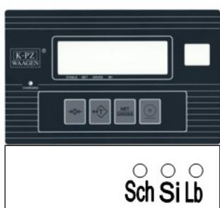
De oplaadconnector (Lb) bevindt zich aan de voorzijde, rechts onder de indicator. Links daarvan bevindt zich een 1A-zekering (Si). Deze zekering beschermt de elektronica tegen overspanning. Indien de indicator niet in te schakelen is, controleert U dan deze zekering en vervang deze eventueel.
