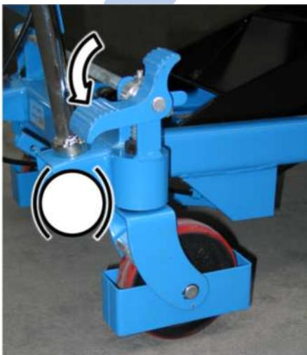
Şekil 5 Frenin etkinleştirilmesi
