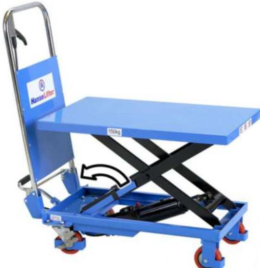
Pre údržbárske práce alebo opravy prestavte poistku proti spusteniu. Presvedčte sa, že sú obe strany prestavené a obe poistky proti spusteniu bezpečne zaistené.
