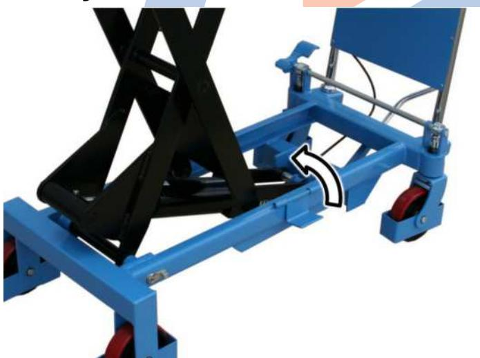
Para efetuar trabalhos de manutenção ou reparação, mova a proteção conforme ilustrado. Certifique-se de que ambos os lados estão dobrados e as duas proteções estão fixas de forma segura.
