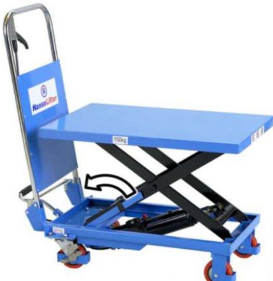
Para efetuar trabalhos de manutenção ou reparação, mova a proteção conforme ilustrado. Certifique-se de que ambos os lados estão dobrados e as duas proteções estão fixas de forma segura.
