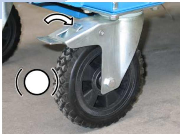
Obrázek 8 Uvolnění brzdy
