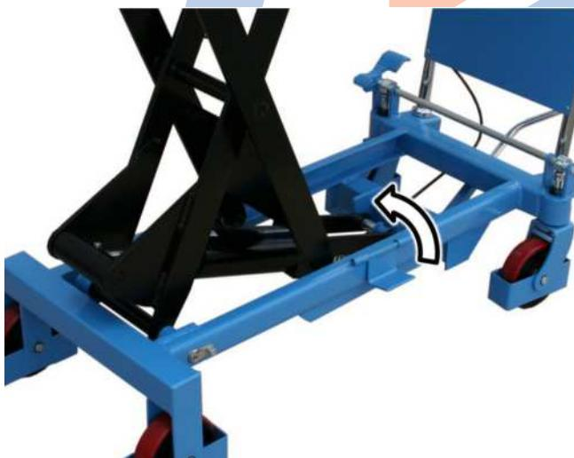
Pre údržbárske práce alebo opravy prestavte poistku proti spusteniu. Presvedčte sa, že sú obe strany prestavené a obe poistky proti spusteniu bezpečne zaistené.
