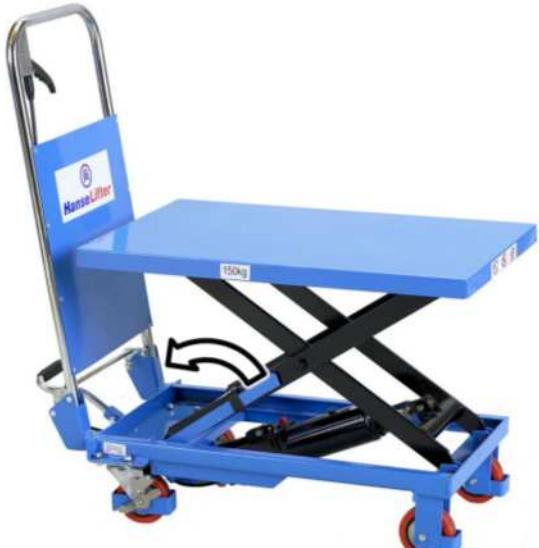
При выполнении обслуживания или ремонта необходимо установить фиксатор от опускания так, как показано на рисунке. Следует убедиться, что рукав поддерживает обе стороны и оба фиксатора надежно закреплены.
