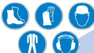
La protezione individuale diretta deve essere garantita con l'utilizzo di adeguati dispositivi di protezione. Può prevenire lesioni e incidenti o ridurne le conseguenze. Indossare sempre indumenti di protezione quando si utilizza il carrello elevatore. Il dispositivo di protezione individuale dovrebbe includere i seguenti elementi:
