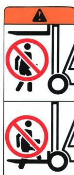
È severamente vietato sostare sotto le forche o le attrezzature. Non importa se sono caricate o libere. Quando il carrello elevatore è parcheggiato, le forche devono essere sempre completamente abbassate per evitare qualsiasi rischio di caduta o pericolo. È vietato stare in piedi o camminare sulle forche o sul carico.
