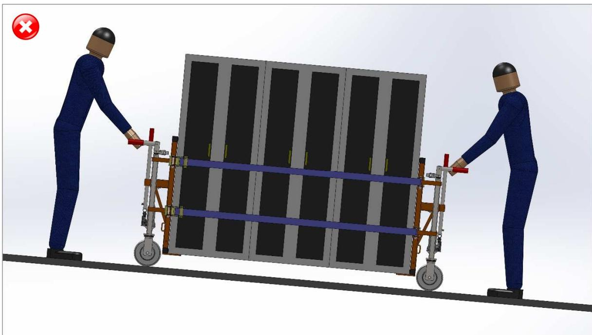
**STOP!** Beim Querfahren niemals am Transportgut oder am Pumpenhebel schieben! Immer nur an den Gerätegriffen schieben.
