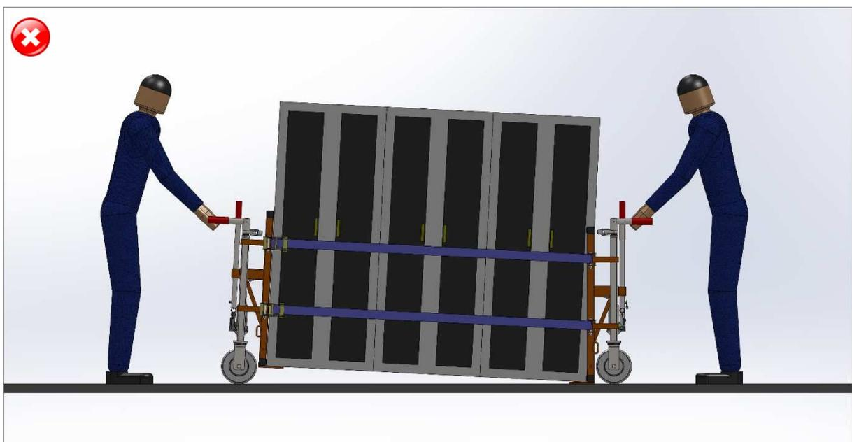
Transportgut immer gleichmäßig auf beiden Seiten hochpumpen. Möglichst bei maximal  $h=50\text{mm}$  Bodenfreiheit des Transportgutes und möglichst nur in Längsrichtung verfahren.
