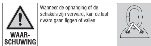
**6.9** Gebruik geschikte aanslagmiddelen. Gebruik alleen lasthaken met borging. Belast de lasthaken alleen in de ronding van de haak. Het is niet toegestaan aanslagmiddelen te draaien of in de knoop te laten raken. Let op de uitgebalanceerde lastverdeling en het draagvermogen van het aanslagmiddel. Zie ook DGUV Informatie 209-013 – aanslagmiddelen en DGUV Regel 100-500, hoofdstuk 2.8: lastopname-inrichtingen in het hefwerkbedrijf.
