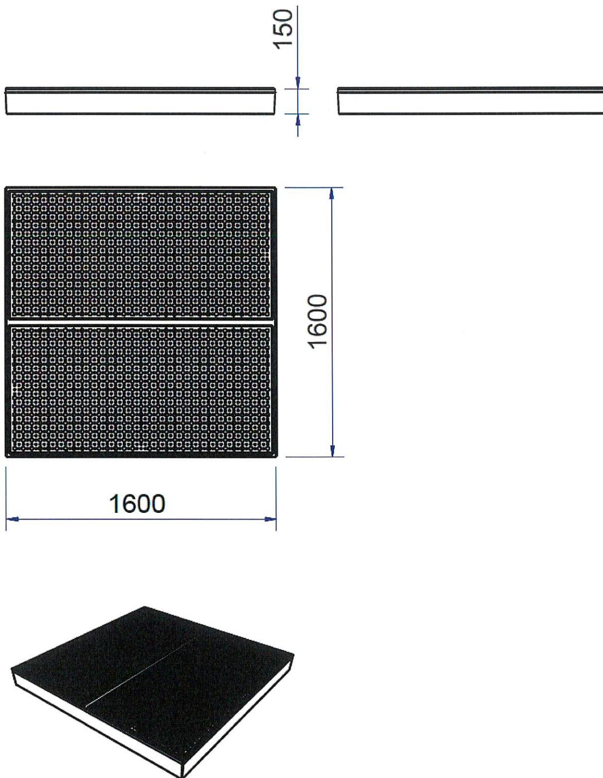
Auffangvorrichtung aus Polyethylen (PE), Typ B
