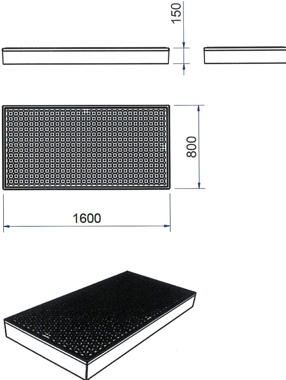
Auffangvorrichtung aus Polyethylen (PE), Typ B
