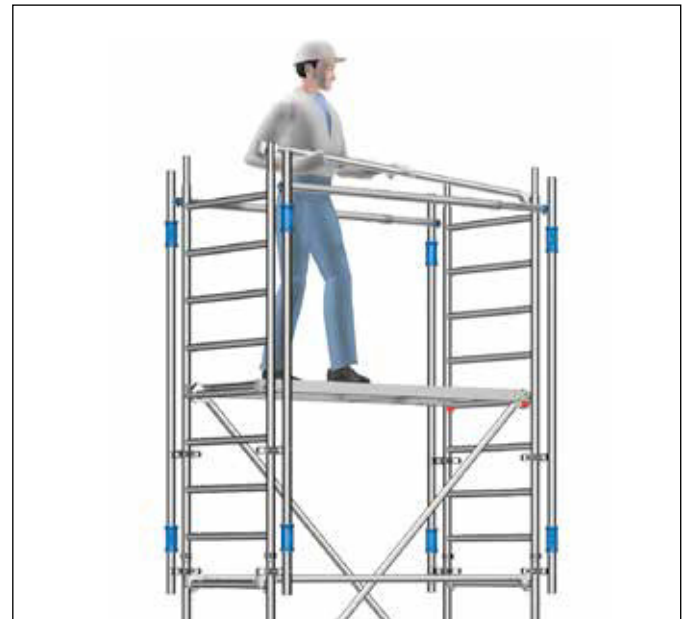
Fig. 6: Colocación segura de las barandillas con AGS
