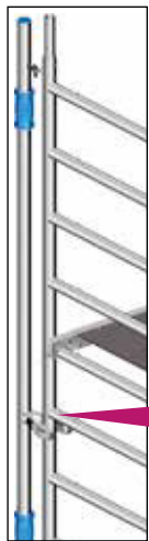
Fig. 4: Conexión del mástil al marco
