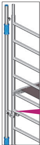
Bild 4: Anschluss Montagepfosten an der Standleiter
