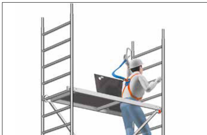
Fig. 1: Enganche del EPI durante el ascenso a un nivel sin asegurar
