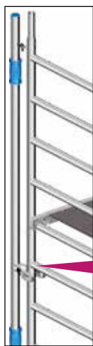
Fig. 4: Conexión del mástil al marco
