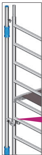
Bild 4: Anschluss Montagepfosten an der Standleiter
