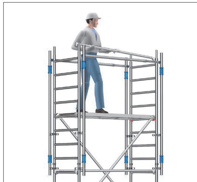
Bild 6: Sichere Montage der Rückenlehnen mit MSG
