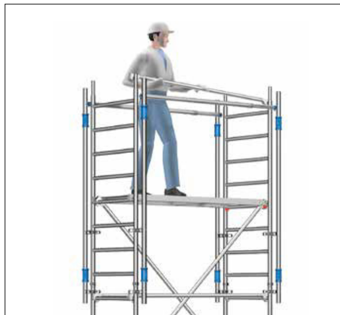
Fig. 6: Colocación segura de las barandillas con AGS
