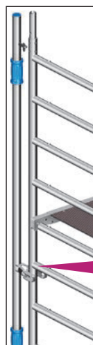
Bild 4: Anschluss Montagepfosten an der Standleiter
