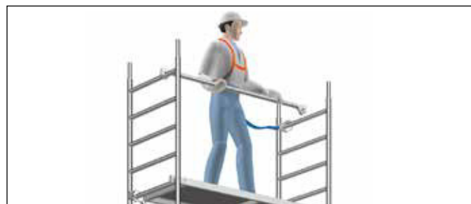
Fig. 3: Colocación de las barandillas con EPI
