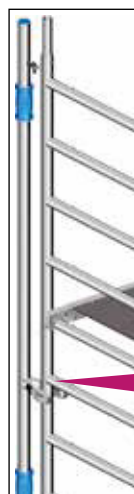
Fig. 4: Conexión del mástil al marco
