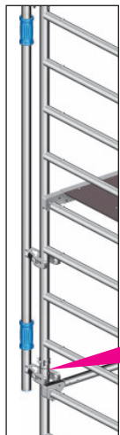
Bild 4: Anschluss Montagepfosten an der Standleiter
