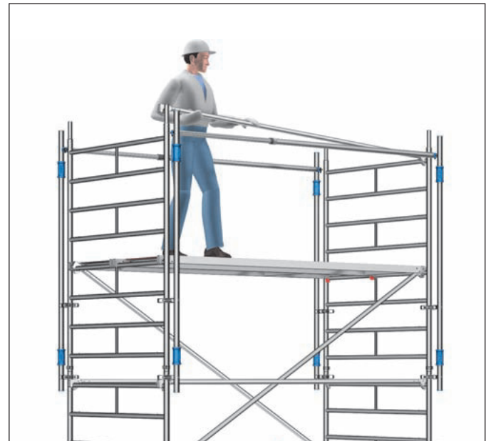
Bild 6: Sichere Montage der Rückenlehnen mit MSG
