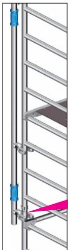
Bild 4: Anschluss Montagepfosten an der Standleiter
