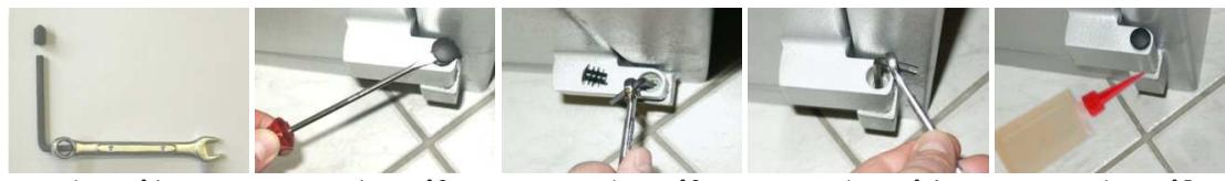
Pour graisser les charnières faites couler quelques gouttes d'huile dans la fente entre la partie haute et la partie basse de la charnière (image n°5) et essuyez l'excès éventuel. Toutes les huiles de graissage standard conviennent.
