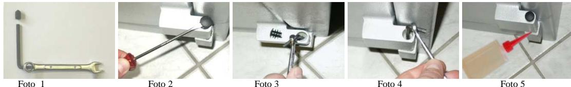
**Het smeren van scharnieren** gaat het beste als er een kleine hoeveelheid olie wordt gedruppeld in de sleuf tussen de bovenste en het onderste deel van een scharnier (foto 5). Verwijder de olieresten. Alle standaard smeeroles kunnen worden gebruikt. De smearfrequentie is afhankelijk van de gebruiksintensiteit van de kast, maar is tenminste één keer per jaar gesmeerd.
