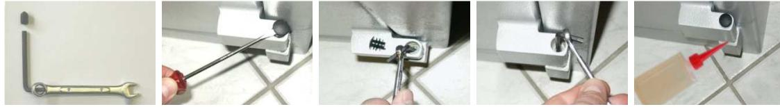
**Do smarowania zawiasów** należy dodać trochę oleju w szczeleinę między górną - dolną częścią zawiasu (zdjęcie 5) i ewentualnie wytrzeć roznany olej. Do smarowania nadają się wszystkie standardowe oleje smarowe.
