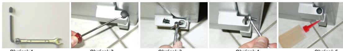
**K mazání pantů** přidejte trochu oleje do mezery mezi horní a dolní části pantu (Obrázek 6) a případně otřete rozlitý olej. Vhodné pro mazání jsou vše standardní mazači oleje.
