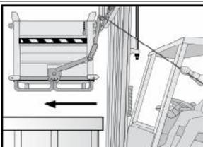
plaats het trekkoord van het openklapmechanisme naast de bestuurdersstoel. Til de container ongeveer 10 cm van de grond. Ga naar de losplaats. Til de container met te openen bodem net boven de verzamelcontainer. Rij naar voren met de machine tot de container ( onderlosser ) zich volledig boven de verzamelcontainer bevindt.
