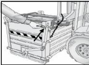
Liberar el mosquetón de seguridad de la palanca para permitir la apertura de la base del contenedor.
