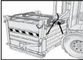
Fixer la chaîne de sécurité du conteneur au porte charge du chariot élévateur.
