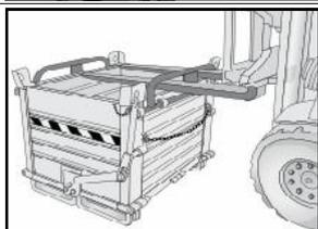
Positionieren Sie die Gabelzinken in den vorgesehenen Einfahrtaschen. Wenn notwendig betätigen Sie den Schalthebel um die Gabeln zu zentrieren.
