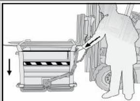
Abbassare a terra le forche fino alla completa chiusura dei fondelli. Nei modelli SL064 e SL153 riagganciare manualmente la leva di sgancio. Nel modello SL154 il riaggancio è automatico. Assicurarsi che i dispositivi di fissaggio dei fondelli siano bene agganciati. Rimettere l'anello di sicurezza alla leva di sgancio fondelli. Riportare il contenitore al proprio posto di raccolta.
