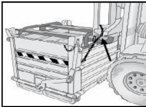
Conectar la cadena de seguridad a la estructura porta horquillas de la carretilla elevadora.
