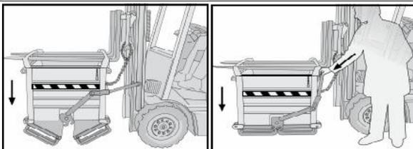
Spustite vidlica na zem až do úplného uzavretia dna. U modelov sa musia SL064 a SL153 páku byť zmenená ručne. Pre model SL154 hákovanie je automatické. Overte, že zariadenie spodnej upevňovacie riadne upevnené. Premiestnite bezpečnostné karabínu na uvoľňovaciu páčku. Vezmite späť kontajner na svoje zberné miesto.
