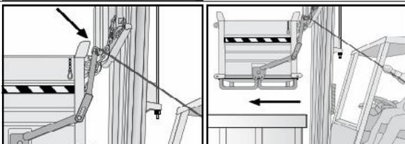
Umístěte uvolňovací páčku lano v blízkosti sedadla řidiče. Zvedněte kontejner o 10 cm od země. Přesuňte se na vykládací plochou. Zvedněte kontejner s otevírací dno těsně nad zápisů sběrné nádoby. Pokročit s vysokozdvizným vozíkem dokud není obal překryly do sběrného kontejneru.
