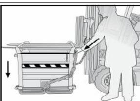
Laat de container op de grond zakken totdat de bodem zich volledig sluit. Voor de modellen SL064 en SL153 moet de ontgrendelhandel handmatig teruggezet worden . Voor het model SL154 vergrendeld deze automatisch. Maak de ketting los van het vorkenbord. Zet de veiligheidsvergrendeling van het openklapmechanisme vast.
