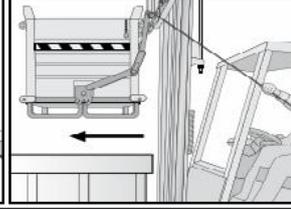
Sürücü koltuğunun yanında serbest bırakma kolunu ipi yerleştirin. Yerden 10 cm konteyner kaldırın. Boşaltma alanına taşıyın. Sadece hurda toplama kabı üzerinde açılabilir alt ile konteyner kaldırın. Konteyner toplama kabına yerleştirilmiştir kadar forklift ile ileri hareket ettirin.
