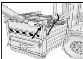
Entfernen Sie den Sicherheitshaken vom Entriegelungshebel des Bodens.
