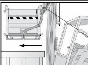
Positionieren Sie das Zugseil des Freilassungshebels beim Fahrersitz. Heben Sie den Behälter zirka 10 cm. Begeben Sie sich in die Entladungszone. Heben Sie den Behälter etwas höher als den Abrollcontainer an. Rücken Sie soweit vor, bis Sie den Klappbodenbehälter über den Großcontainer positioniert haben.
