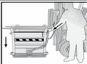
Descender las horquillas de la carretilla hasta que las puertas del contenedor se hayan cerrado completamente. Para los modelos SL064 y SL153 la palanca se debe reposicionar manualmente. Para el modelo SL154 la palanca se reposiciona automáticamente. Asegurarse que los anclajes de cierre de las puertas inferiores están correctamente posicionados. Volver a colocar el mosquetón de seguridad en su posición original. Devolver el contenedor a su posición inicial.
