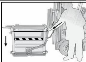
Abaxe os garfos para o chão, até o encerramento total do fundo. Para os modelos SL064 e SL153 alavanca a liberação deve ser reposicionado manualmente. Para o modelo SL154 a ligar é automático. Verifique se os dispositivos de fixação inferior são devidamente corrigido. Reposicionar o mosquetão de segurança para a alavanca de liberação. Leve de volta o recipiente para o seu lugar coleção.
