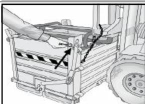
Odstraňte bezpečnostní karabinu z páky na spodní otevření.
