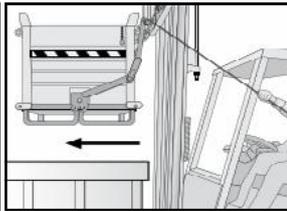
Posicionar el cable de la palanca cerca del conductor de la carretilla. Elevar el contenedor unos 10cm del suelo. Desplazarlo hasta la zona de vaciado. Elevar el contenedor de fondo abatible ligeramente por encima del contenedor de residuos. Avanzar con la carretilla elevadora hasta asegurarse que el contenido caerá dentro del contenedor de residuos.
