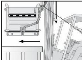
Coloque a corda alavanca perto do banco do motorista. Levantar o contentor de cerca de 10 cm do chão. Mover para a área de descarga. Levante o recipiente com fundo openable apenas sobre o recipiente de coleta sucatas. Avançar com o empilhador até que o recipiente é sobreposto ao recipiente de coleta.
