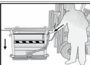
Senken Sie die Gabeln auf den Boden bis zur vollständigen Schließung der Klappen. Bei den Modellen SL 064 und SL 153 hängen Sie manuell den Entriegelungshebel wieder ein. Bei dem Modell SL 154 erfolgt dieser Mechanismus automatisch. Versichern Sie sich, dass das Befestigungszubehör der Klappen gut eingehakt ist. Bringen Sie den Sicherheitsring wieder am Hebel der Klappen an. Befördern Sie den Behälter an seine übliche Sammelstelle.
