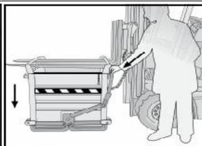
Engedje le a villát a földre, amíg a konténer teljes lezáródása meg nem történik. Az SL064 és az SL153 model esetében a kioldó szerkezetet manuálisan kell vissza rögzíteni. Az SL154 esetében ez automatikusan történik. Ellenőrizze, hogy az alsó rögzítő szerkezet megfelelően van – e fixálva. Helyezze vissza a biztonsági karabinert a kioldó szerkezetre. Ezt követően a konténer visszakerülhet a felhasználási helyre.
