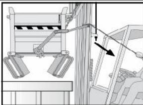
Tirar del cable para accionar la palanca y abrir las puertas de la base del contenedor.
