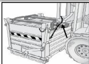
Łańcucha podłączyć bezpieczeństwa pojemnika do przodu belki z wózka.
