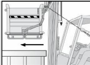
Posizionare il tirante o il cordino della leva sgancio al posto di guida del carrello. Sollevare il contenitore di circa 10 cm da terra. Portarsi presso la zona di scarico. Sollevare il contenitore ad una altezza appena superiore a quella del cassone di scarico. Avanzare fino a sovrapporre il contenitore al cassone di scarico.
