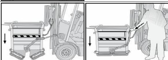
Nižší vidlice na zem až do úplného ukončení dna. U modelů se musí SL064 a SL153 páku být změněna ručně. Pro model SL154 hákování je automatické. Ověřte, že zařízení spodní upevňovací řádně upevněny. Přemístěte bezpečnostní karabinu na uvolňovací páčku. Vezměte zpět kontejner na své sběrné místo.
