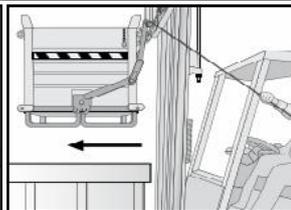
Helyezze a kioldó szerkezet kábelét közel a targoncavezetőhöz. Emelje fel a konténert ( k. 10 cm – re ) . Menjen az ürítési helyre. Emelje az alul nyitható konténert a gyűjtő konténer magassága felé. Menjünk előre a targoncával addig, amíg a konténer a gyűjtő konténer fölé nem kerül.
