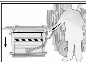
Опустите вилы в землю до полного закрытия нижней части. Для моделей SL064 и SL153 рычаг должен быть повторно вручную. Для модели SL154 подключение происходит автоматически. Убедитесь, что устройства нижнего крепления закреплен надлежащим образом. Установите на безопасность карабин, чтобы рычаг. Заберите контейнер для своей коллекции место.
