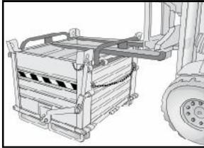
Posizionare le forche nelle apposite maniglie di inforcazione mantenendo i montanti di sollevamento del carrello in posizione verticale. Se necessario agire sul traslatore per centrare i punti di inserimento delle forche.
