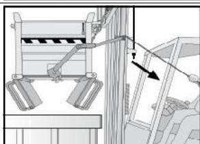
Ziehen Sie und lassen Sie den Verriegelungshebel los, somit öffnet sich der Klappboden des Behälters um den Inhalt zu entladen.
