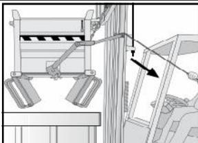
Tirer sur le levier de déblocage, au même moment les trappes de fond s'ouvrent pour le vidage du contenant.
